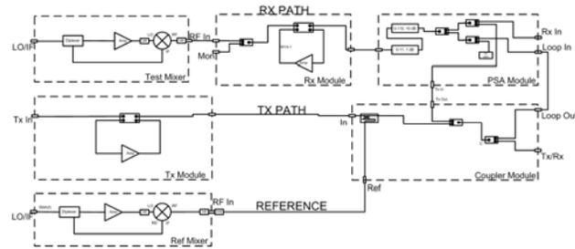
**Figure 5 – RTM Block Diagram**
